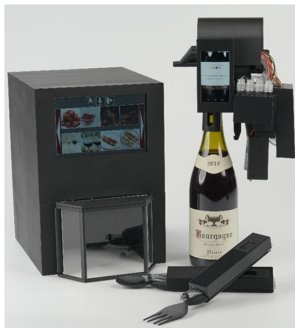
図 2 調味家電 TTTV3, ボトル装着型調味家電 TTTVin, 試作中のスプーン・フォーク型調味食器(溶液混合版)。
